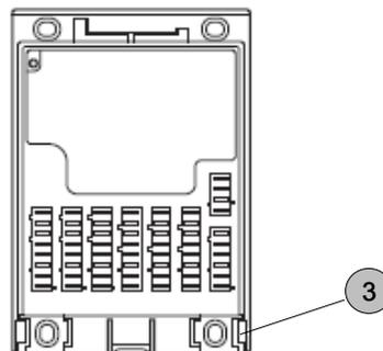
3 Aufnahmeschlitze für Führungsbügel
